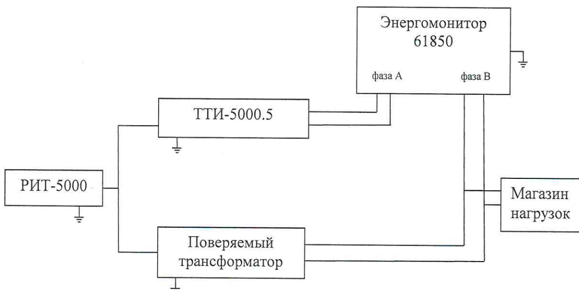
Рисунок 2 – Схема определения погрешностей коэффициента масштабного преобразования, угла фазового сдвига (для трансформаторов классов точности TPX; TPY; TPZ) и погрешности по виткам (для трансформаторов классов точности PX; PXR)
