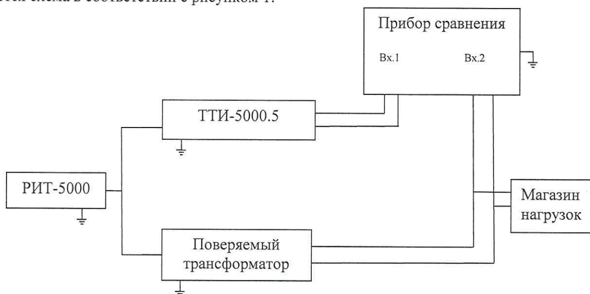
Рисунок 1 – Схема определения токовых и угловых погрешностей трансформаторов классов точности 0,2S; 0,2; 0,5S; 0,5; 1; 3; 5P; 10P; 5PR 10PR
