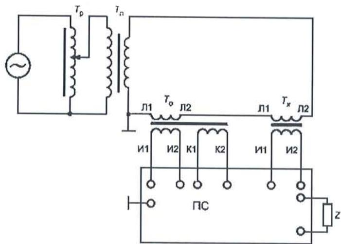
$\sim$  - сеть (генератор);  $T_p$  - регулирующее устройство (автотрансформатор);  $T_n$  - понижающий силовой трансформатор;  $T_o$  - рабочий эталон;  $T_x$  - поверяемый трансформатор тока;  $L_1$ ,  $L_2$  - контактные зажимы первичной обмотки;  $I_1$ ,  $I_2$  - контактные зажимы вторичной обмотки;  $K_1$ ,  $K_2$  - контактные зажимы дополнительной вторичной обмотки;  $Z$  - нагрузка; ПС - прибор сравнения типа КТ-01
