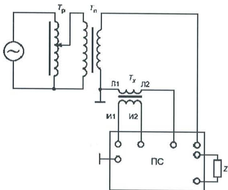
~ - сеть (генератор);  $T_p$  - регулирующее устройство (автотрансформатор);  $T_n$  - понижающий силовой трансформатор;  $T_x$  - поверяемый трансформатор тока;  $L_1$ ,  $L_2$  - контактные зажимы первичной обмотки;  $I_1$ ,  $I_2$  - контактные зажимы вторичной обмотки;  $Z$  - нагрузка; ПС - прибор сравнения типа К-535
