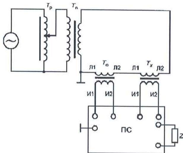
$\sim$  - сеть (генератор);  $T_p$  - регулирующее устройство (автотрансформатор);  $T_n$  - понижающий силовой трансформатор;  $T_o$  - рабочий эталон;  $T_x$  - поверяемый трансформатор тока;  $L_1$ ,  $L_2$  - контактные зажимы первичной обмотки;  $I_1$ ,  $I_2$  - контактные зажимы вторичной обмотки;
