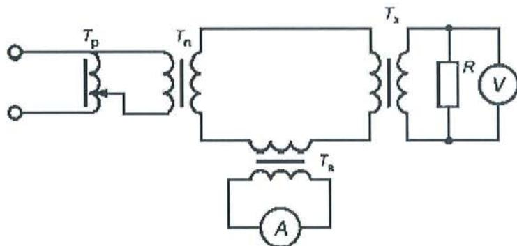
$T_p$  - регулирующее устройство (автотрансформатор);  $T_n$  - понижающий силовой трансформатор;  $T_x$  - поверяемый трансформатор тока;  $T_b$  - вспомогательный трансформатор тока;  $R$  - резистор
