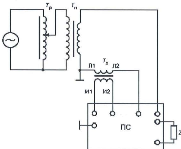
$\sim$  - сеть (генератор);  $T_p$  - регулирующее устройство (автотрансформатор);  $T_n$  - понижающий силовой трансформатор;  $T_x$  - проверяемый трансформатор тока;  $\Pi_1, \Pi_2$  - контактные зажимы первичной обмотки;  $\text{И}_1, \text{И}_2$  - контактные зажимы вторичной обмотки;  $Z$  - нагрузка; ПС - прибор сравнения типа К-535
