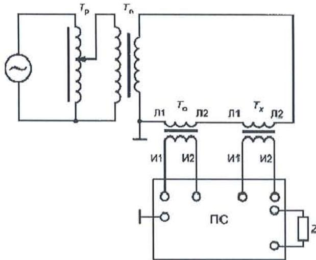
$\sim$  - сеть (генератор);  $T_p$  - регулирующее устройство (автотрансформатор);  $T_n$  - понижающий силовой трансформатор;  $T_o$  - рабочий эталон;  $T_x$  - поверяемый трансформатор тока;  $Л_1, Л_2$  - контактные зажимы первичной обмотки;  $И_1, И_2$  - контактные зажимы вторичной обмотки;  $Z$  - нагрузка; ПС - прибор сравнения
