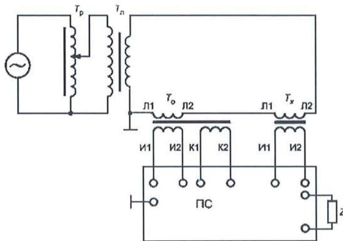
$\sim$  - сеть (генератор);  $T_p$  - регулирующее устройство (автотрансформатор);  $T_n$  - понижающий силовой трансформатор;  $T_o$  - рабочий эталон;  $T_x$  - поверяемый трансформатор тока;  $Л_1, Л_2$  - контактные зажимы первичной обмотки;  $И_1, И_2$  - контактные зажимы вторичной обмотки;  $К_1, К_2$  - контактные зажимы дополнительной вторичной обмотки;  $Z$  - нагрузка; ПС - прибор сравнения типа КТ-01
