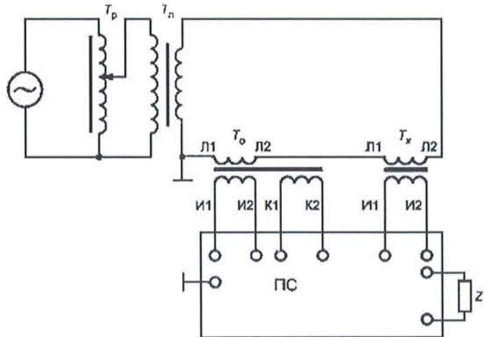
$\sim$  - сеть (генератор);  $T_p$  - регулирующее устройство (автотрансформатор);  $T_n$  - понижающий силовой трансформатор;  $T_o$  - рабочий эталон;  $T_x$  - поверяемый трансформатор тока;  $\text{L}_1, \text{L}_2$  - контактные зажимы первичной обмотки;  $I_1, I_2$  - контактные зажимы вторичной обмотки;  $K_1, K_2$  - контактные зажимы дополнительной вторичной обмотки;  $Z$  - нагрузка; ПС - прибор сравнения типа КТ-01
