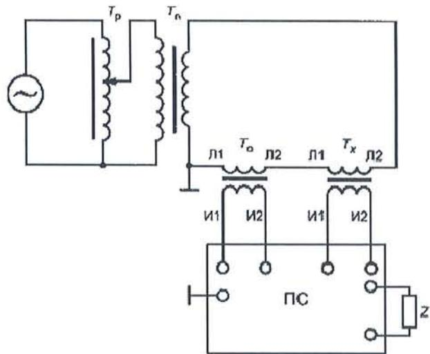
$\sim$  - сеть (генератор);  $T_p$  - регулирующее устройство (автотрансформатор);  $T_n$  - понижающий силовой трансформатор;  $T_o$  - рабочий эталон;  $T_x$  - поверяемый трансформатор тока;  $\text{L}_1, \text{L}_2$  - контактные зажимы первичной обмотки;  $I_1, I_2$  - контактные зажимы вторичной обмотки;
