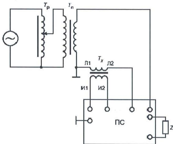
$\sim$  - сеть (генератор);  $T_p$  - регулирующее устройство (автотрансформатор);  $T_x$  - понижающий силовой трансформатор;  $T_x$  - поверяемый трансформатор тока;  $\text{Л}_1$ ,  $\text{Л}_2$  - контактные зажимы первичной обмотки;  $\text{И}_1$ ,  $\text{И}_2$  - контактные зажимы вторичной обмотки;  $Z$  - нагрузка; ПС - прибор сравнения типа К-535
