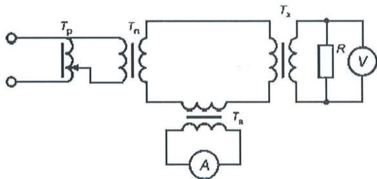
$T_p$  - регулирующее устройство (автотрансформатор);  $T_{\pi}$  - понижающий силовой трансформатор;  $T_x$  - поверяемый трансформатор тока;  $T_b$  - вспомогательный трансформатор тока;  $R$  - резистор
