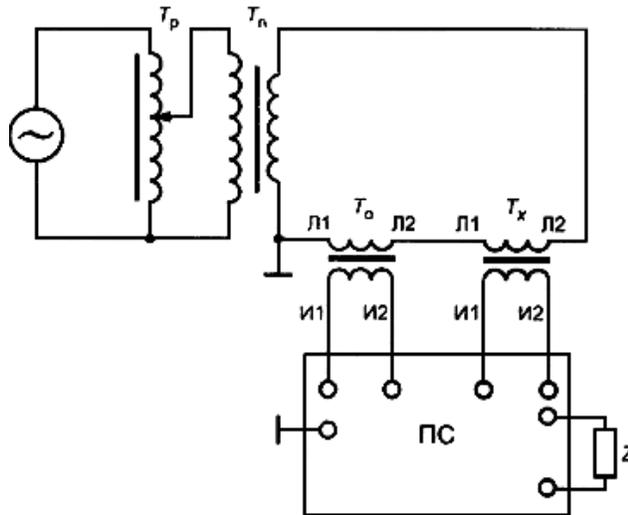
$\sim$  - сеть (генератор);  $T_p$  - регулирующее устройство (автотрансформатор);  $T_{п}$  - понижающий силовой трансформатор;  $T_0$  - рабочий эталон;  $T_x$  - поверяемый трансформатор тока;  $\Pi_1, \Pi_2$  - контактные зажимы первичной обмотки;  $И_1, И_2$  - контактные зажимы вторичной обмотки;  $Z$  - нагрузка; ПС - прибор сравнения
