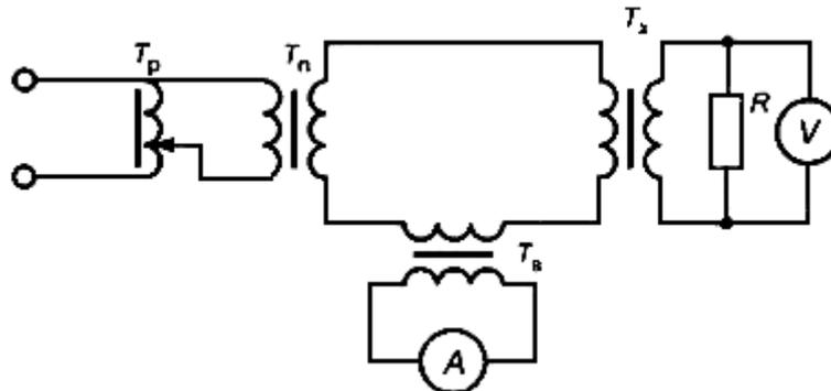
$T_p$  - регулирующее устройство (автотрансформатор);  $T_n$  - понижающий силовой трансформатор;  $T_x$  - проверяемый трансформатор тока;  $T_B$  - вспомогательный трансформатор тока;  $R$  - резистор
