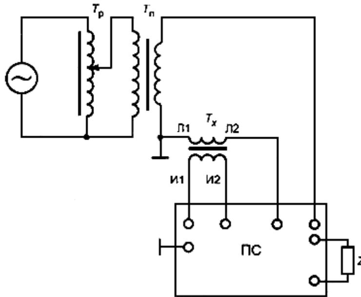
$\sim$  - сеть (генератор);  $T_p$  - регулирующее устройство (автотрансформатор);  $T_n$  - понижающий силовой трансформатор;  $T_x$  - проверяемый трансформатор тока;  $L_1, L_2$  - контактные зажимы первичной обмотки;  $I_1, I_2$  - контактные зажимы вторичной обмотки;  $Z$  - нагрузка; ПС - прибор сравнения типа К-535
