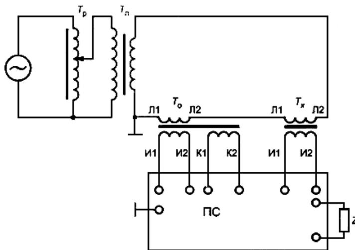
$\sim$  - сеть (генератор);  $T_p$  - регулирующее устройство (автотрансформатор);  $T_{п}$  - понижающий силовой трансформатор;  $T_0$  - рабочий эталон;  $T_x$  - поверяемый трансформатор тока;  $\Pi_1, \Pi_2$  - контактные зажимы первичной обмотки;  $И_1, И_2$  - контактные зажимы вторичной обмотки;  $K_1, K_2$  - контактные зажимы дополнительной вторичной обмотки;  $Z$  - нагрузка; ПС - прибор сравнения типа КТ-01
