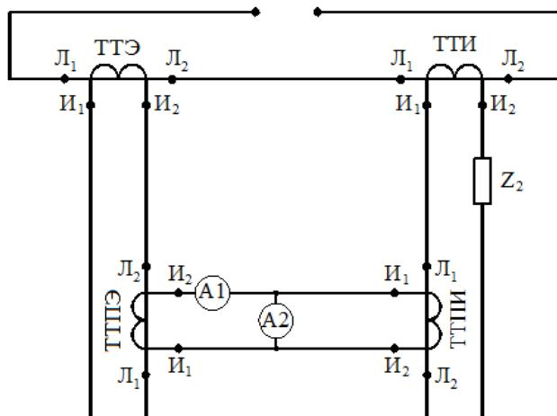
ТТЭ – эталонный трансформатор тока; ТТИ – испытуемый трансформатор тока;
